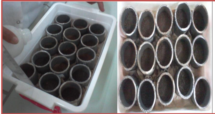
Figure 16 : la mesure de capacité de rétention.
