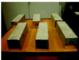
Figure 3. Éprouvettes prismatiques carbonatation recouvertes d'une feuille d'aluminium adhésive.
