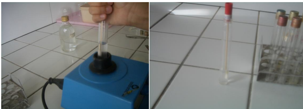
Agitation au vortex de la solution mère et préparations des solutions décimales.
