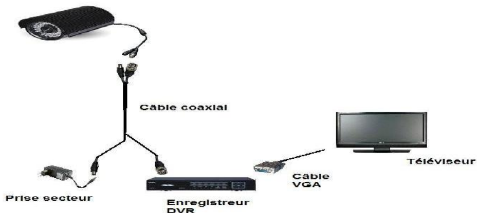
Figure -9- Système de télésurveillance filaire (câble coaxial)
