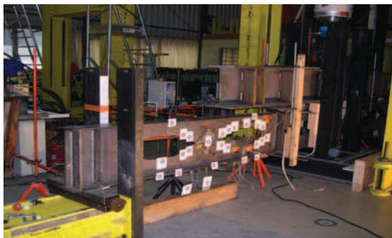
Figure 7. Photographie illustrant le montage d'une poutre, le chevêtre, les anti-déversements avec le vérin.
