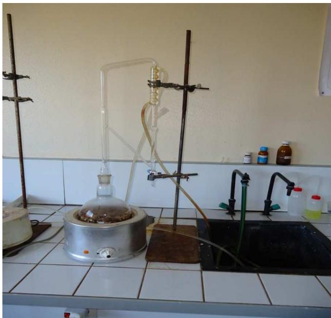
**Figure 17 :** L'appareil d'extraction des huiles essentielles par hydrodistillation « Clevenger »
