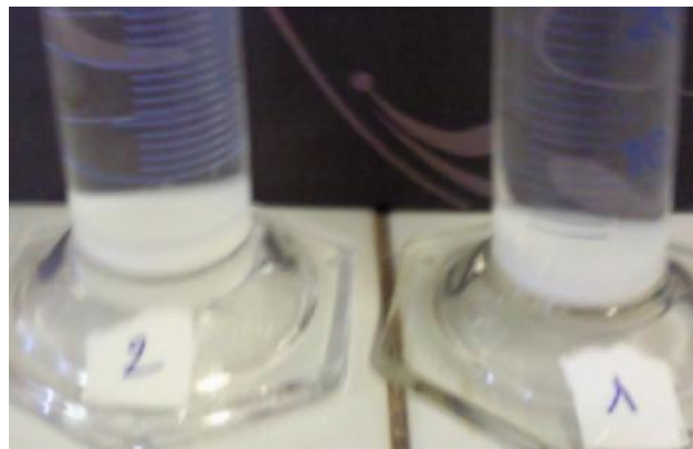
Figure III.11 : Résultat de test de sédimentation de PG150-St100; 1 :2ml et 2 :5ml de solution 30%
