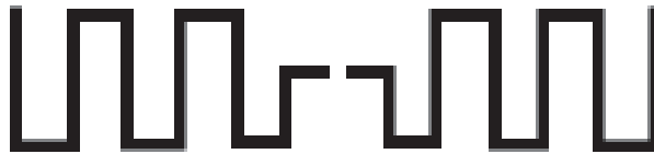
Figure II-7 : Exemple de méandres appliqués à un dipôle.
