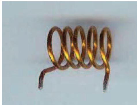
Figure 6 : Bobine à spires non jointives de fil de cuivre.
