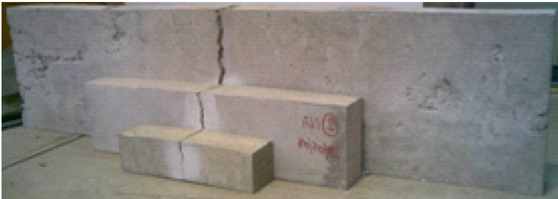
Fig.4.31. Photo des poutres après l'essai Yassir Alam [84].
