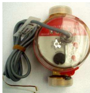
Figure II .20 : Le compteur d'énergie
