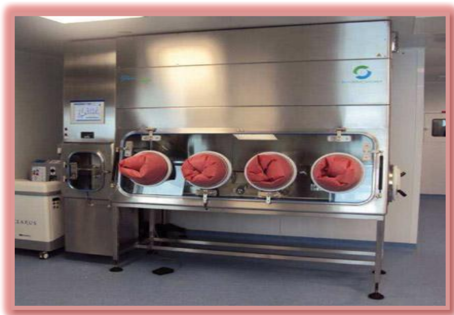
Figure19 : Isolateur stérilisateur pour les opérations aseptiques
