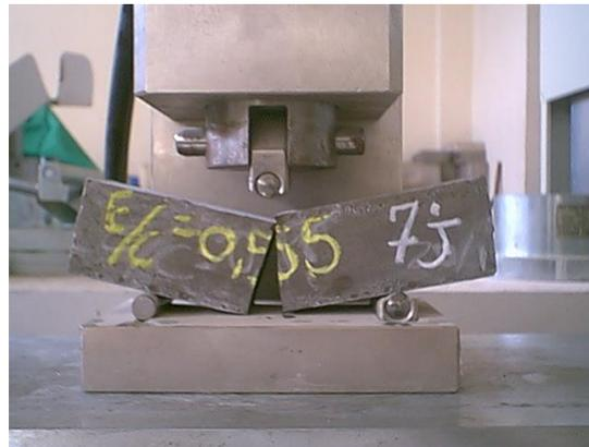
*Photo 3.11* : Essai de traction par flexion
