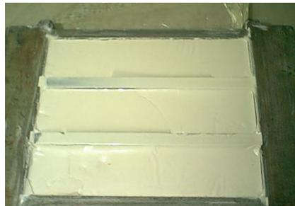
**Photo 3.8 :** Eprouvettes de coulis de chaux
