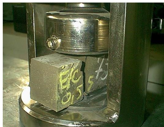
*Photo 3.12* : Essai de compression simple
