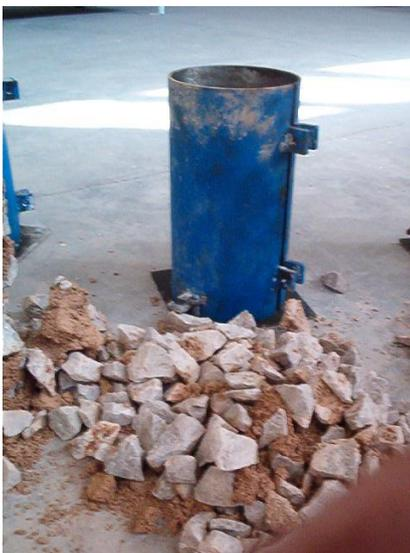
**Photo 3.22:** Remplissage de porosité 40%
