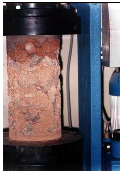
**Photo 3.23:** Remplissage de porosité 32%
