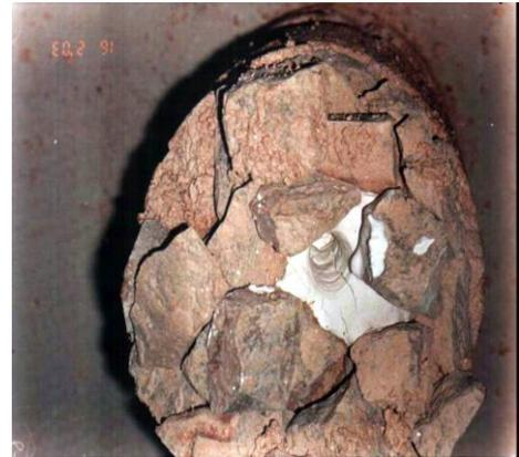
**Photo 3.29 :** Epreuve injectée de chaux avant surfacage
