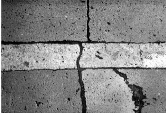
**Figure 2.21 :** Détail des fissures après injection du coulis maintenu sous pression et sciage du muret (le coulis a pénétré dans les fissures situées à l'interface mortier-brique. Le joint de mortier a une épaisseur d'environ 10 mm).
