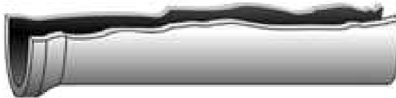
Figure III.12 : Mode de rupture d'une canalisation dans le cas d'une fissuration Longitudinale.
