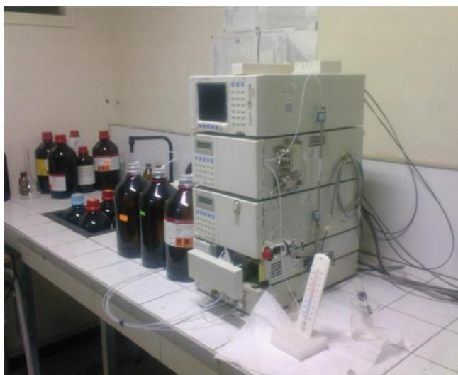
**Figure 2.1** : Description du système RP-HPLC utilisé
