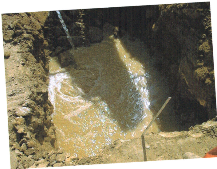
Photo 11.7 Essai de perméabilité (grés)
