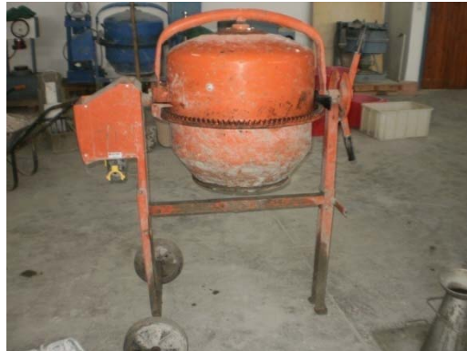
Figure 2. 1 Malaxeur d'une capacité de 125 litres
