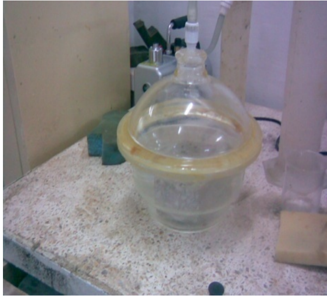
Figure 2. 5 Dispositif utilisé pour mesurer de la porosité accessible à l'eau : Dessiccateur et pompe à vide.
