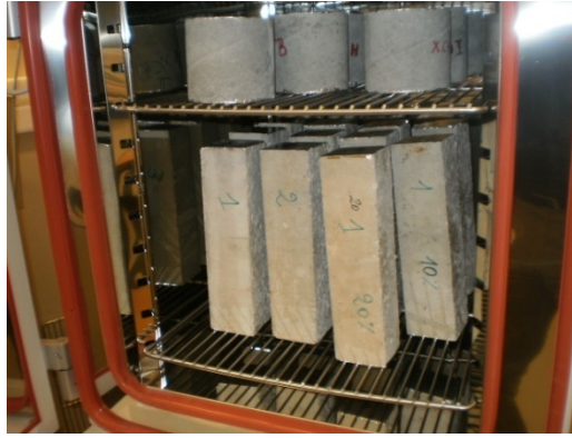
Figure 2. 10 Enceinte climatique assurant l'homogénéisation.
