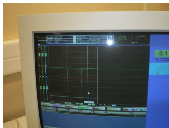
Figure 2. 8 Ecran de contrôle de la température et du taux d'humidité relative à l'intérieur de l'enceinte
