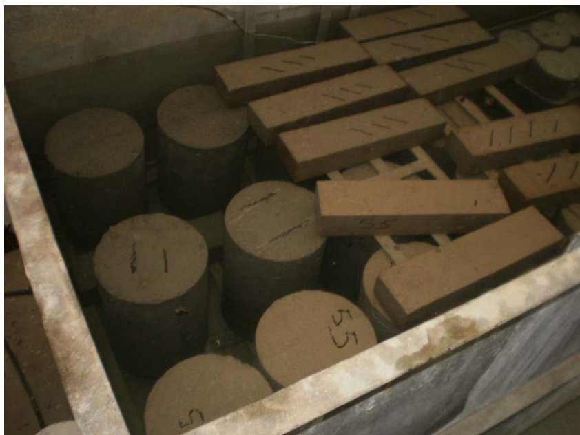
Figure 2. 4 Cure des éprouvettes (immersion totale dans l'eau).
