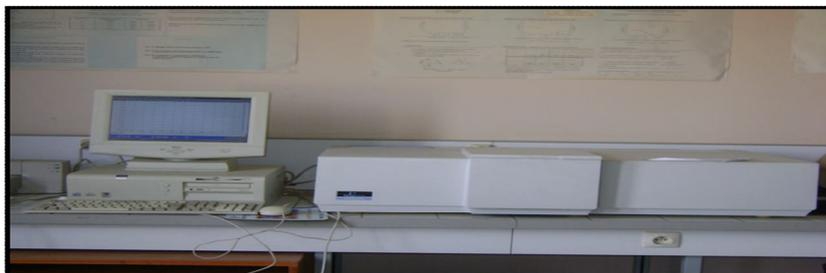
Figure 7: Appareil de l'Ultraviolet-visible Perkin-Elmer Lambda 800
