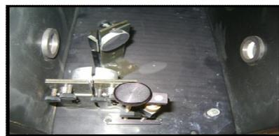
Figure 6 : Mante religieuse servant aux mesures UV-Vis pour des solides.
