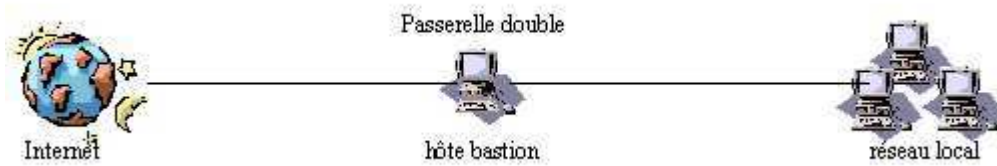
Figure 2.5 : Passerelle double ou réseau bastion
