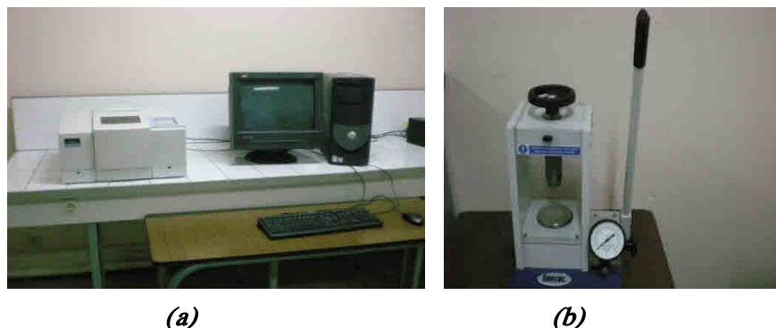
Figure II.3 : (a) schéma de l'appareil Infrarouge, (b) pastilleuse
