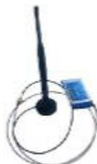
**Figure II-17 :** Carte WIFI connectée à une antenne.
