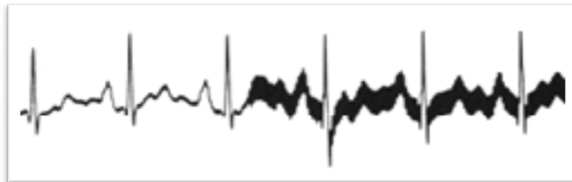
Figure III.1 -Interférences du champ magnétique à 50Hz venant du secteur sur le tracé électro-cardiographique.
