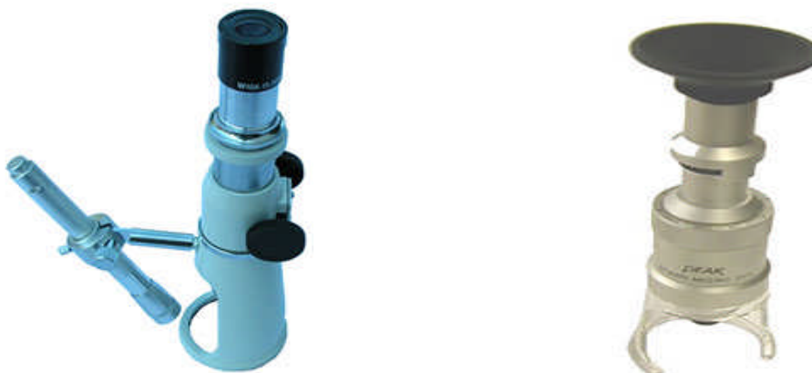
Figure 1.18 : Lunette micrométrique avec réglette interne gradué pour la mesure d'une fissure.
