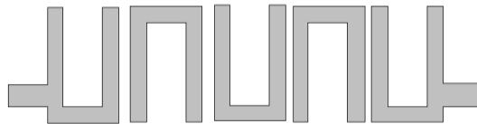
Figure II.16: Layout d'un filtre à résonateurs en U couplés.
