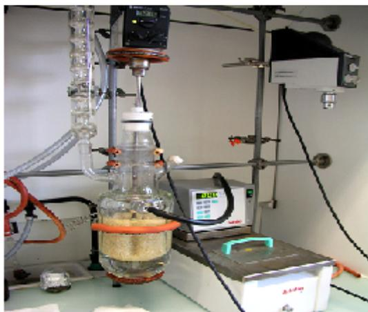
**Figure 4** : Réacteur à double enveloppe pour polymérisation en suspension
