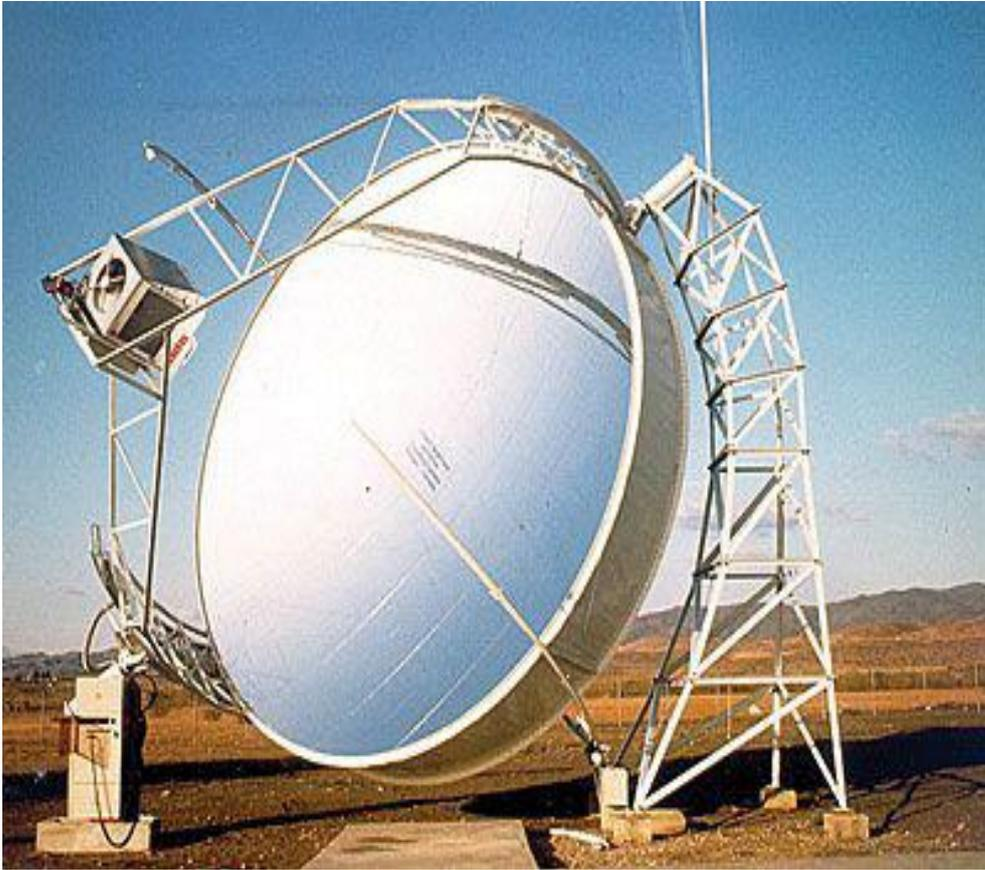
Figure II.8: Capteur parabolique avec moteur Stirling
