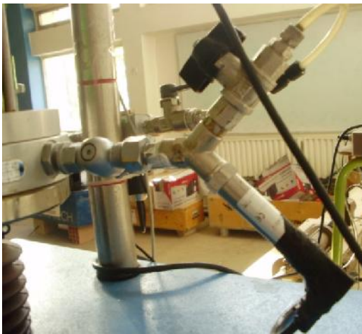
Figure 4.9 : Branchement des capteurs de pression interstitielles ( 1 : capteur absolue, 2 : capteur relatif, 3 : robinet de pression interstitielle fermé).
