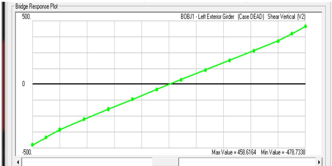
**Figure 4.5 : Diagramme de l'effort tranchant en KN.****1.4.1.2. Poutre intermédiaire :**
