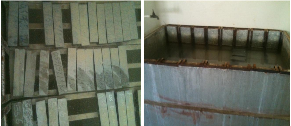
Figure 4. 5 Le mûrissement des éprouvettes
