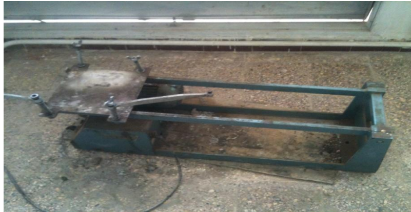
Figure 4. 3 La table à secousses
