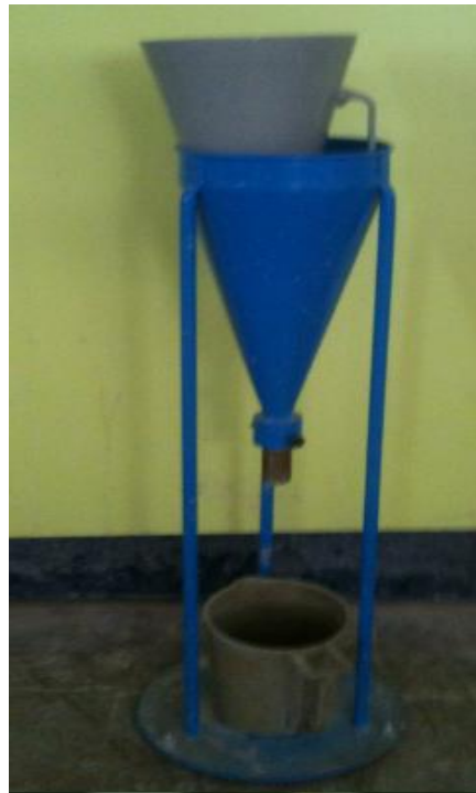
Figure 3. 12 Essai de cône de Marsh
