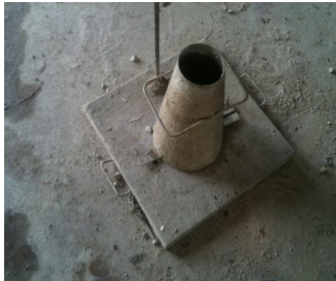
Figure 4. 10 Le cône d'Abrams
