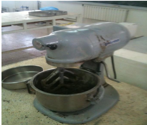
Figure 4. 1 L'appareil de malaxage
