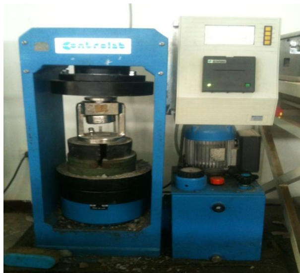
Figure 4. 6 Machine d'essai de compression
