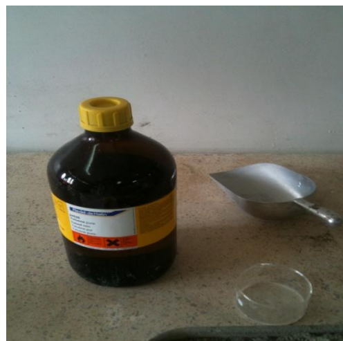
Figure 3. 11 Le toluène pour déterminer la masse volumique absolue de ciment
