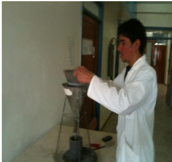
Figure 3. 10 Détermination de la masse volumique apparente
