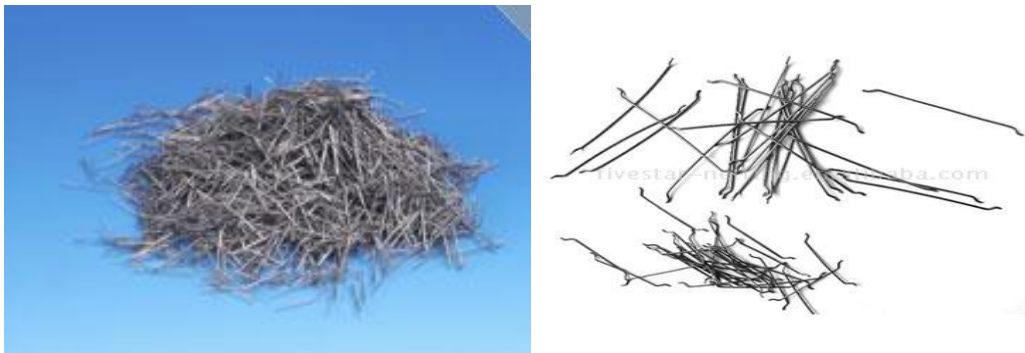
Figure 4. 8 Les fibres métalliques
