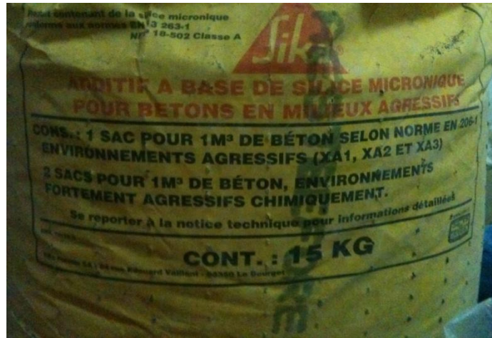
Figure 2. 15 Sac de 15 kg de fumée de silice
