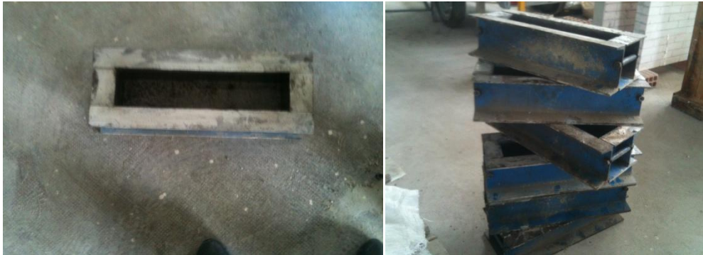
Figure 4. 9 Les éprouvettes de 10 \times 10 \times 40 \text{ cm}^3
