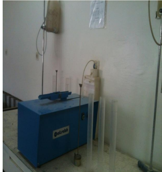
Figure 3. 3 Essai d'équivalent de sable
