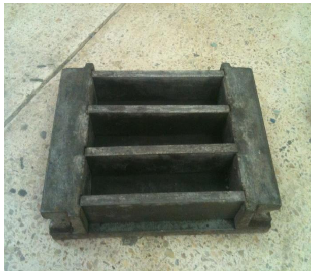
Figure 4. 2 Le moule de 4 \times 4 \times 16 \text{ cm}^3
