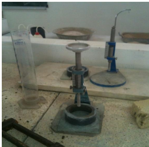
Figure 3. 14 L'appareil de Vicat
