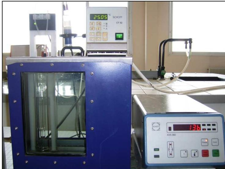
**Figure II.5:** Viscosimètre à capillaire utilisé type Ubbelohde
