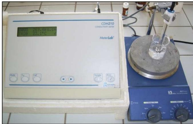
**Figure II.9:** Conductimètre utilisé avec sa cellule électrolytique
