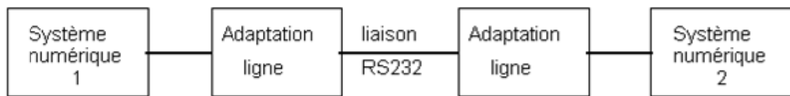
Figure 2.14 : schéma fonctionnel d'une liaison série asynchrone de la norme RS232
