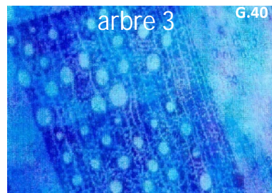
Figure 06 : Coupe transversale de la zone externe du chêne vert
