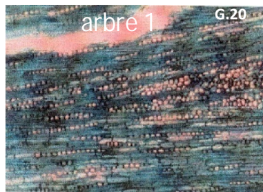
Figure 07 : Coupe tangentielle du chêne vert
