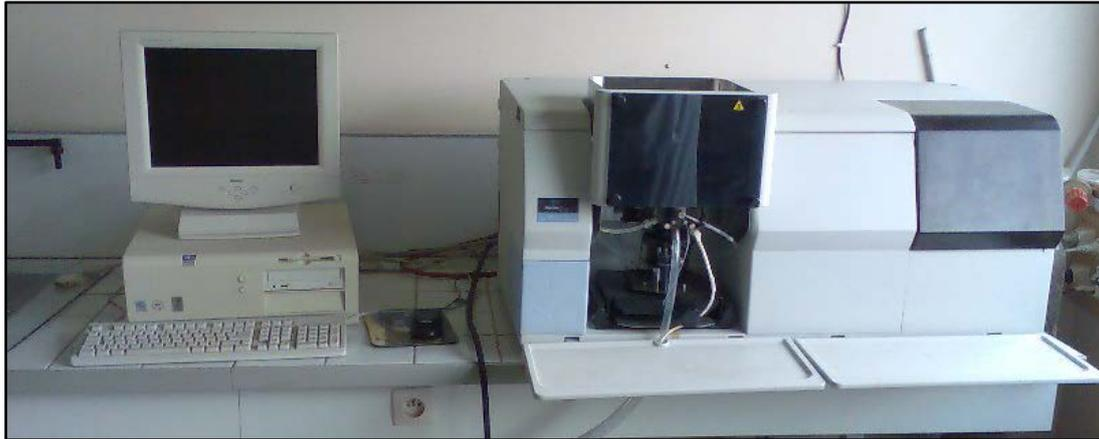
**Photo1** : Photo d'un spectrophotomètre d'absorption atomique PERKIN-ELMER A analyst 300.
