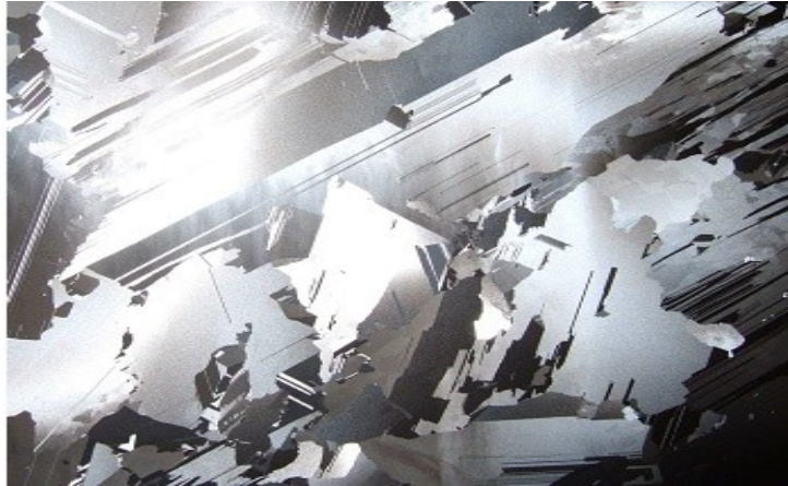
Figure 1.5 : photo d'un substrat de silicium multicristallin [1].
