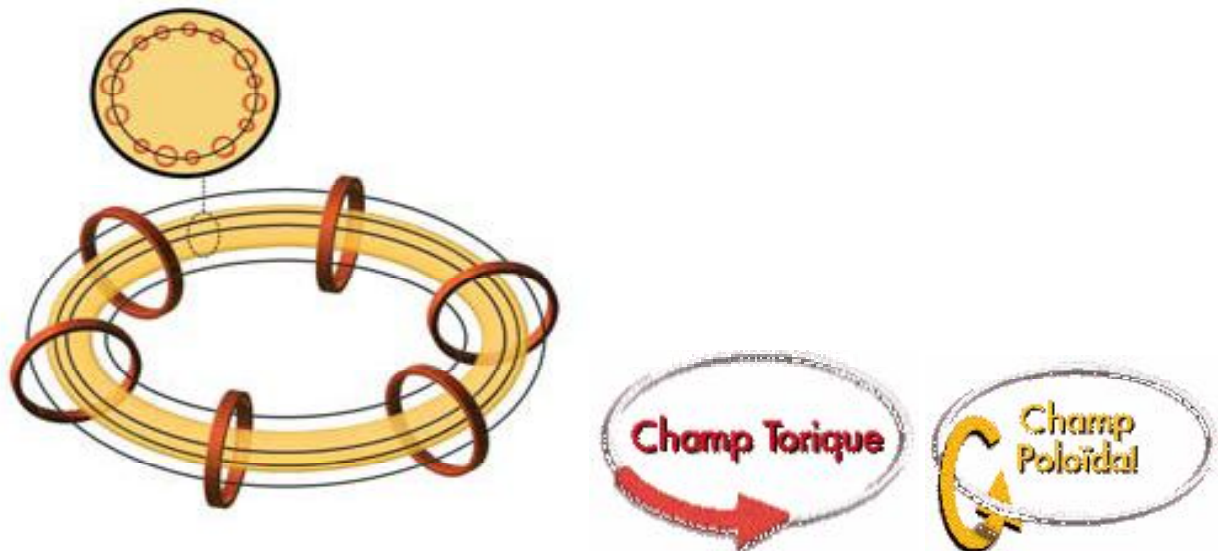
Figure 1-12: Les lignes de champs toroïdales et poloïdales
