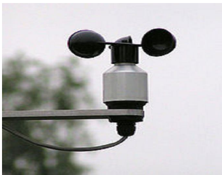
Figure I-7 : Anémomètre à coupelles (Dit de Robinson) [7]
