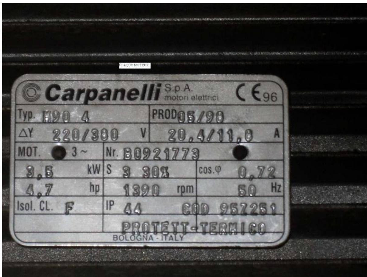
Figure 5.8 : Plaque signalétique du moteur
