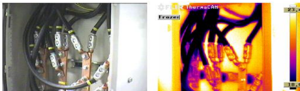
Figure 4.25 : Objet cible plus froid réfléchissant un environnement plus chaud
