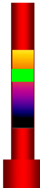
Figure 4.10 : L'isotherme remplace certaines couleurs par des tons opposés
