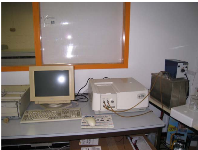
Figure 2.3 : Photo du spectrophotomètre UV / VIS de type JASCOW V – 530.
