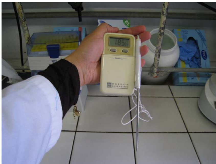
Figure 2.4 : Photo montrant la sonde de température ORGANO SCIENTIFIC, model SA880SSX.
