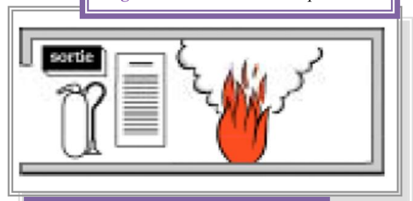
Figure 207: Extincteurs mobiles au niveau des dégagements
