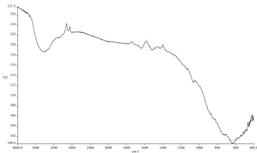
Figure 33: Spectre IR du matériau 5% RuO_2/V_2O_5-Al_2O_3 .
