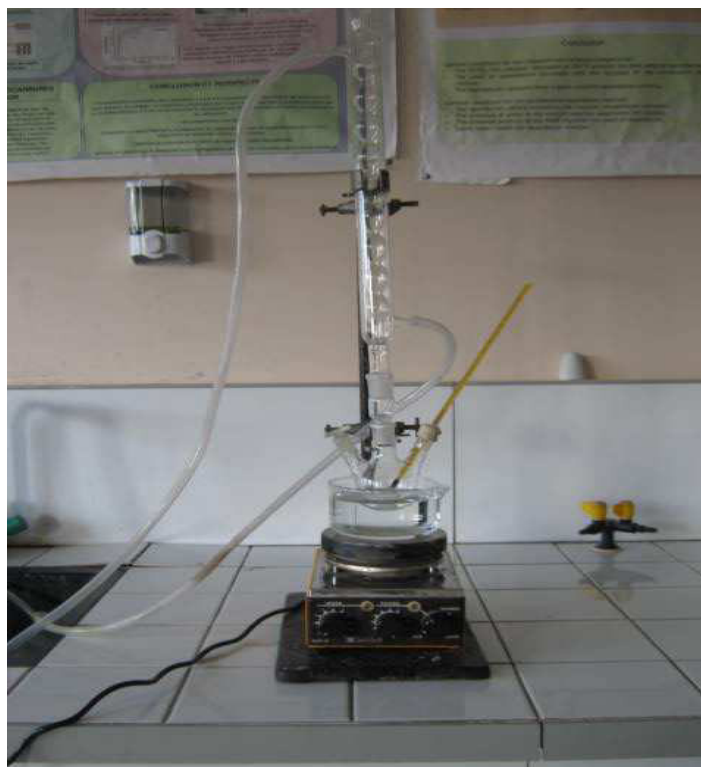
Figure 10 : Schéma du montage de la réaction d'oxydation du cyclohexane.
