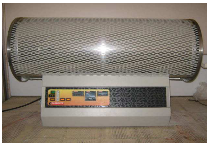
Figure 2: Four utilisé pour la calcination des échantillons.
