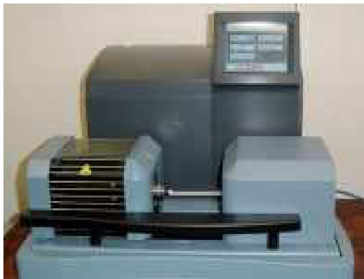
Figure 7 : Appareil d'analyse thermique « SDT Q600 instrument »
