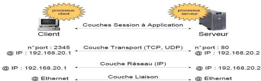
Figure I.4: Modèle OSI et sockets
