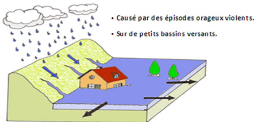
Figure 08 : Inondation par ruissellement en secteur urbain. [MERABET 2006]
