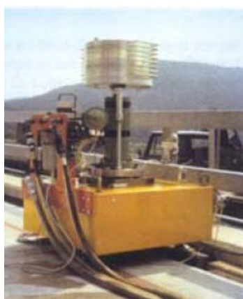
Figure 3.3. Vibreur hydraulique pour exciter les ponts verticalement et les barrages latéralement (Michael I., et Friswel., 2007).
