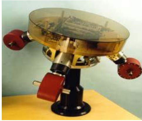
Figure (I.9) : Contrôle d'attitude par Gyroscopes
