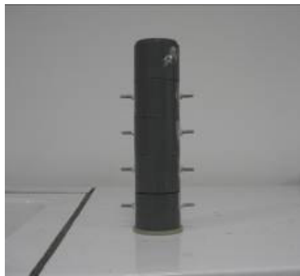
Photo 4.5 - Dispositif utilisé dans la cellule cylindrique \phi 5 cm et hauteur 25 cm.
