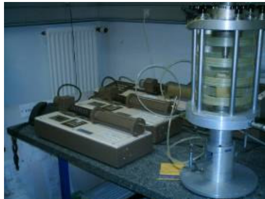
Photo 4. 1 - dispositif de mesure de la perméabilité (perméamètre à paroi souple) LMPG Université le Havre, France.
