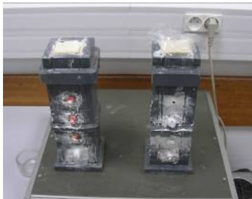
Photo 4.3 - Dispositif utilisé dans la cellule prismatique 5 \times 5 \times 25 \text{ cm}^3
