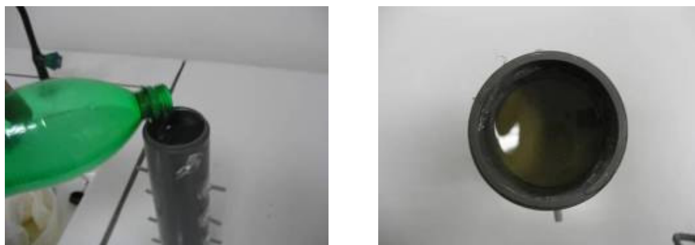
Photos 4.9 : phase de remplissage du réservoir
