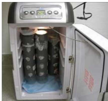
Photo 4.11 : stockage des cellules à température constante (25°C)
