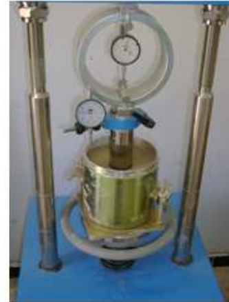
Essai IPI du sédiment de Cheurfas
