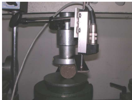
Photo 6.6. Illustration de l'essai de compression diamétrale.
