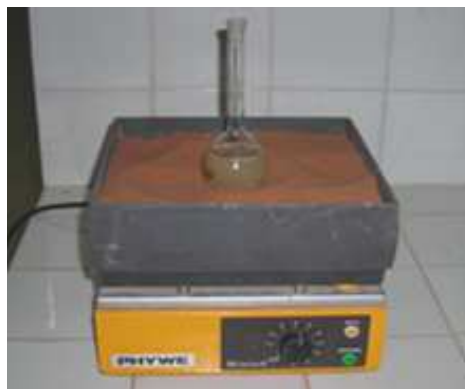
Photo 4.6. Détermination de \gamma_s par l'essai au pycnomètre
