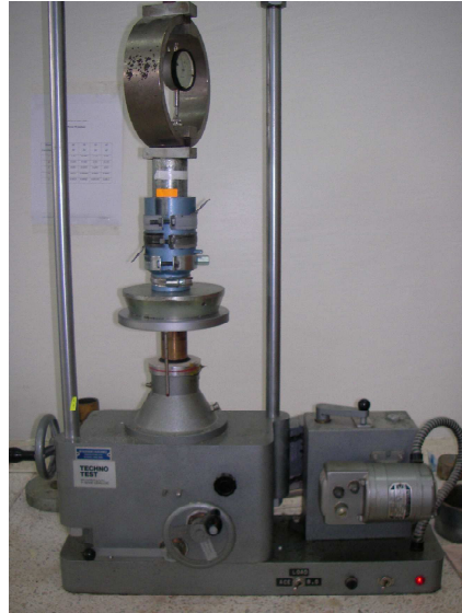
Photo 6.7. Confection des éprouvettes (5x5) cm par compactage statique pour les essais d'aptitude des liants au traitement.
