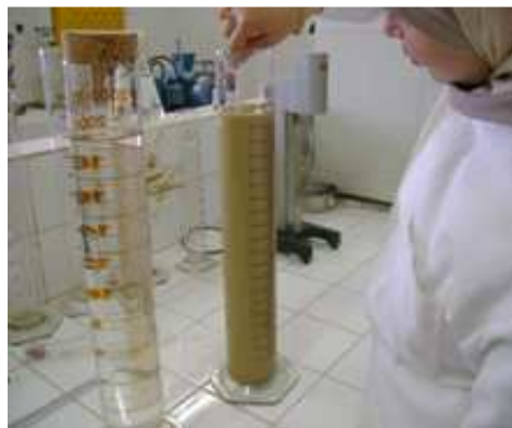
Photo 4.5. Détermination de la distribution granulométrique par l'essai de sédimentométrie
