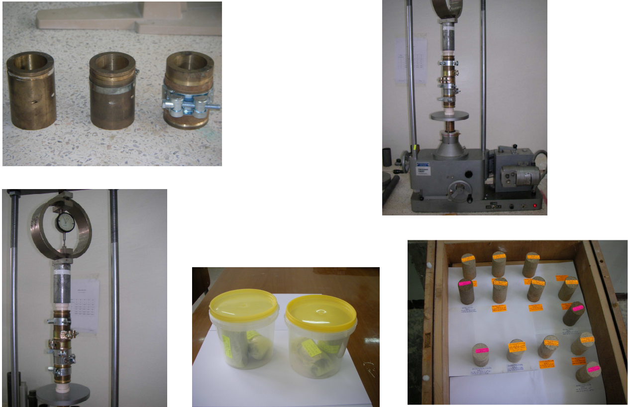
Photo 6.3. Illustration des opérations de confection, conservation et de séchage des éprouvettes pour écrasement.
