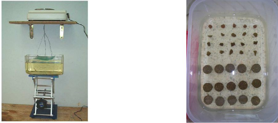
Photo 6.21. Détermination des paramètres d'état ( w , \gamma_d , e , S_r ) par utilisation de pesées hydrostatiques avec de l'huile de kerdane
