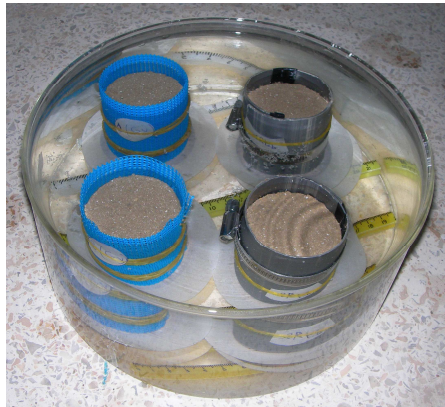
Eprouvettes immergées après confection Eprouvettes immergées à une température de 40°C
