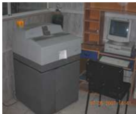
Photo 4.13. Détermination de la minéralogie par l'analyse de fluorescence X (cimenterie de Saida, Algérie)
