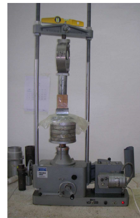
Photo 7.2. Compactage statique des échantillons à différentes compacités (w, \gamma_d ) pour essais de cisaillement direct
