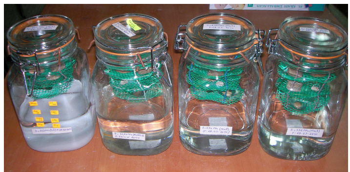
Ensemble de bocaux des solutions salines saturées
