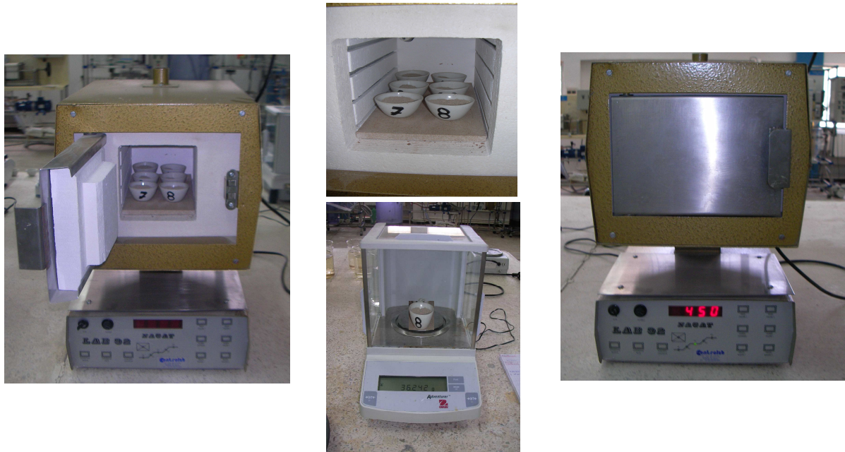
Photo 6.1. Calcination à 450°C des combinaisons de mélanges.
