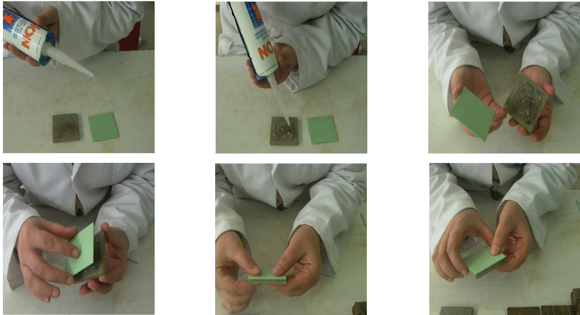
Photo 7.3. Collage et fixation du géotextile Armater sur la pierre poreuse supérieur de la boîte de Casagrande.
