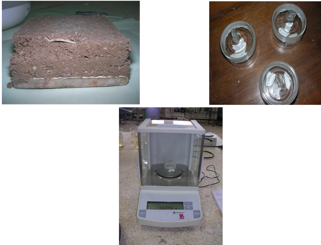
Photo 7.6. Introduction du papier wattman 42 dans les échantillons compactés et mesure de leurs sucions en fin d'essai de cisaillement direct
