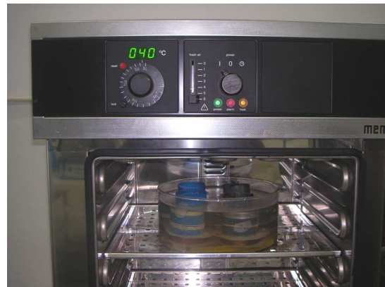
Eprouvettes immergées après confection Eprouvettes immergées à une température de 40°C
