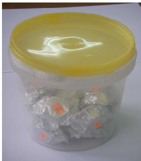
Ensemble d'échantillons compactés à l'OPM du sédiment de Cheurfas
