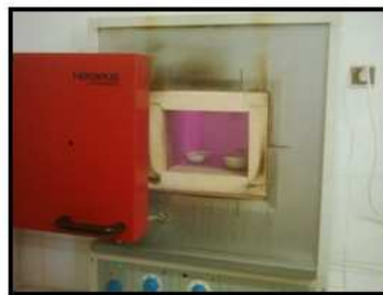
Introduction du sédiment sec au four à 550°C
