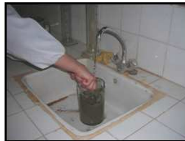
Remplissage et trempage du sédiment naturel par l'eau du robinet
