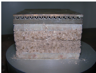
Interface Non saturé sol-sol à w = 6\% , \sigma_v = 3 \text{ bars}
