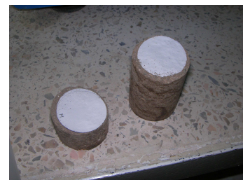
Photo 5. Mesure de la succion d'un sol par la méthode du papier filtre
