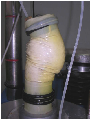
Apparition de plan de rupture après cisaillement
