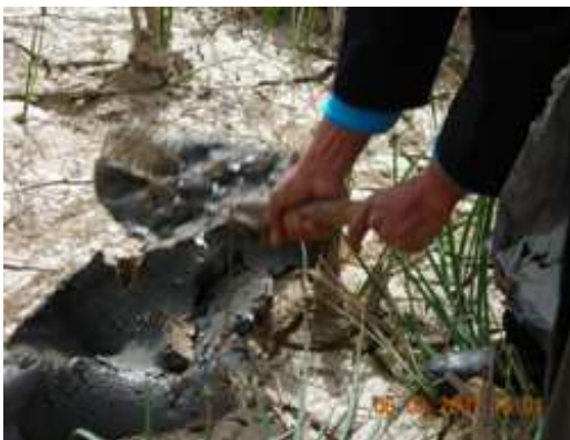
Photo 4.4. Prélèvement du sédiment de dragage
