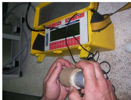
Photo 6.5. Mesure du module d'élasticité E par la méthode d'auscultation dynamique ou ultrason.
