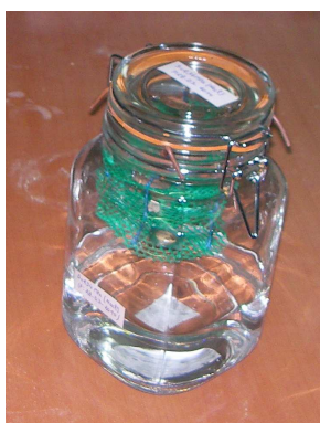
Pose des échantillons dans les bocaux des solutions salines saturées
