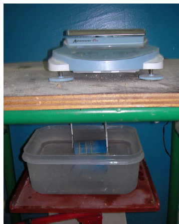
Photo 6.9. Mesure du volume final des échantillons confectionnés pour les essais d'aptitude au traitement par pesée hydrostatique
