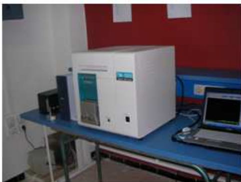
Photo 4.14. Microscopie électronique à balayage HITACHI TM 1000 avec le porte échantillon (Laboratoire de microscopie, Faculté des sciences, Université de Tlemcen)
