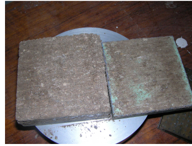
Interface Non saturé sol-GEO à w=6\% , \sigma_v = 3\text{bars}
