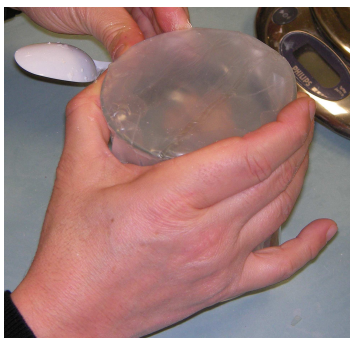
Fermeture du bécher par un couvercle de parafilm
