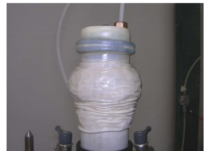
Déformation en forme de tonneau après cisaillement
