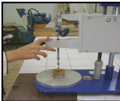
Photo 4.7. Détermination de W_L par l'essai du pénétromètre à cône
