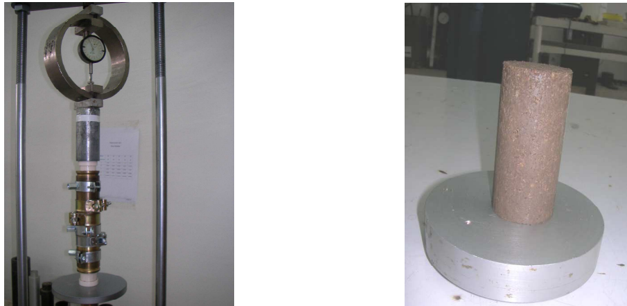
Photo 6.14. Compactage par double compression statique d'une éprouvette de mélange pour un essai triaxial
