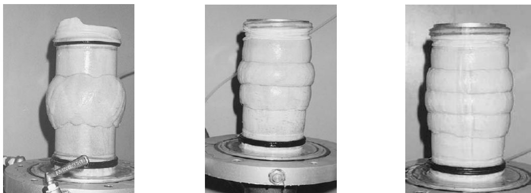
Figure 3.15. Photos d'échantillons cisailés (Haeri et al., 2000)
