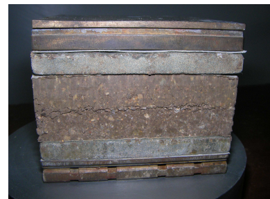
Interface Non saturé sol-sol à w_{\text{OPM}} , \sigma_v = 3 \text{ bars}
