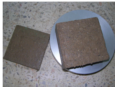
Interface Saturé sol-GEO à w_{OPM} , \sigma_v = 3\text{bars}
