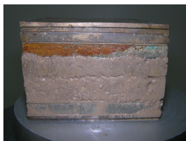
Interface Saturé sol-sol à w_{\text{OPM}} , \sigma_v = 3 \text{ bars}
