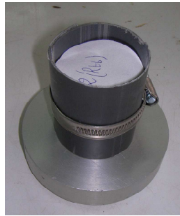
Eprouvettes confectionnées pour essais d'aptitude au traitement (Rtb (gauche) et Gv (droite))
