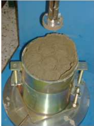
Compactage du sédiment de Cheurfas
