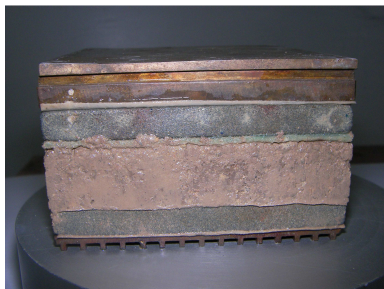
Interface Saturé sol-GEO à w_{OPM} , \sigma_v = 3\text{bars}
