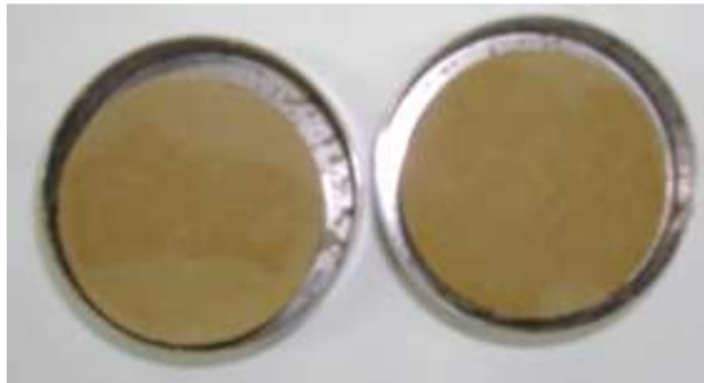
Photo 4.8. Potentiel de retrait élevé visible lors de l'essai de retrait
