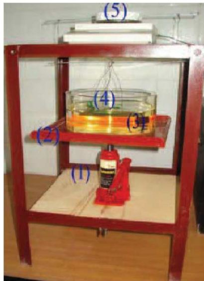
(1) : Dispositif de levage ; (2) : Support ; (3) : Kerdane ; (4) : Echantillon ; (5) : Balance de précision 10^{-2} g Photo 4. Mesures des paramètres d'état ( e , w , \gamma_d et S_r ) par utilisation de l'huile de Kerdane
