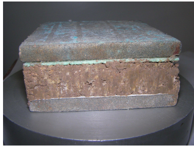
Interface Non saturé sol-GEO à w_{OPM} , \sigma_v = 3\text{bars}
