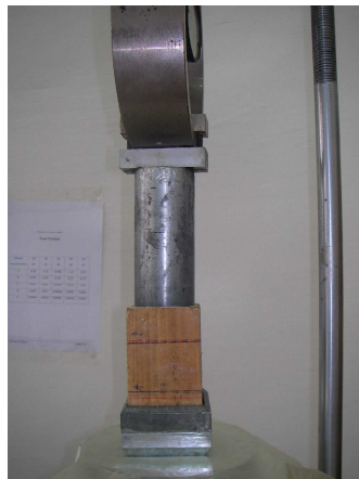
Photo 7.2. Compactage statique des échantillons à différentes compacités (w, \gamma_d ) pour essais de cisaillement direct
