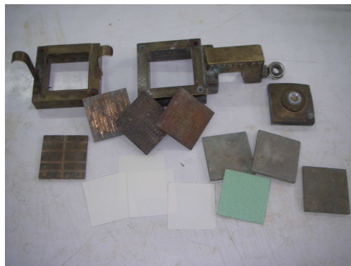
Photo 7.4. Accessoires de pièces utilisées pour les essais d'interaction sol-géotextile dans la boîte de cisaillement direct de Casagrande
