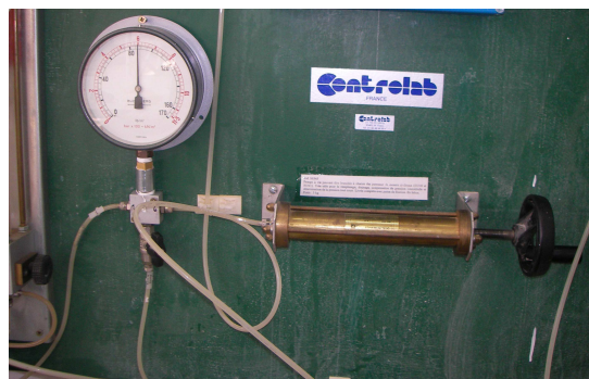
Photo 6.13. Dispositif d'application de la contrainte totale de confinement par utilisation d'un vérin hydraulique.
