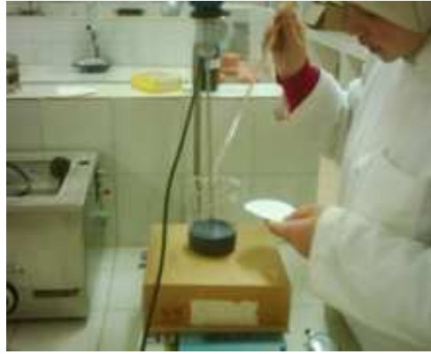
Photo 4.9. Détermination du VBS (et SST) par l'essai au bleu de méthylène
