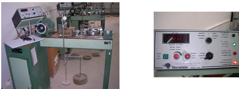
Photo 7.7. Consolidation et cisaillement des échantillons (sol-géotextile (Armater)) dans l'appareil de cisaillement direct
