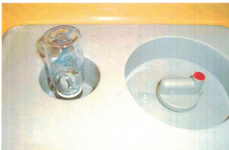
Figure 9: Flacon d'éluion sous vide placé sur l'aiguille du générateur
