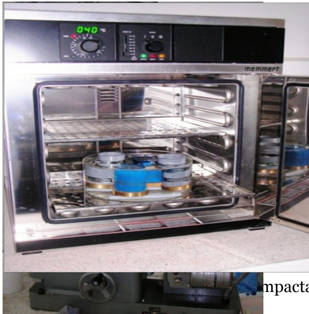
Photo (5.9): Confection des éprouvettes d'essais mécaniques par compactage statique
