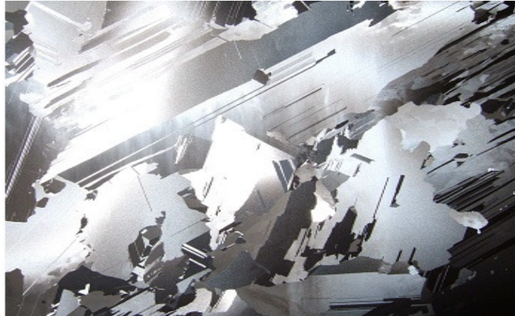
Figure I.12 : photo d'un substrat de silicium multicristallin [21] .
