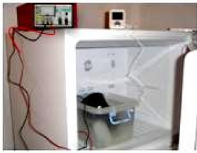
Figure III.5 Réfrigérateur utilisé pour les essais à basses températures
