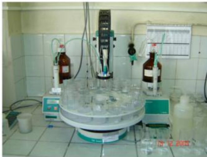
Figure II.19 Titrimètre pour le dosage des chlorures [MAH, 06]
