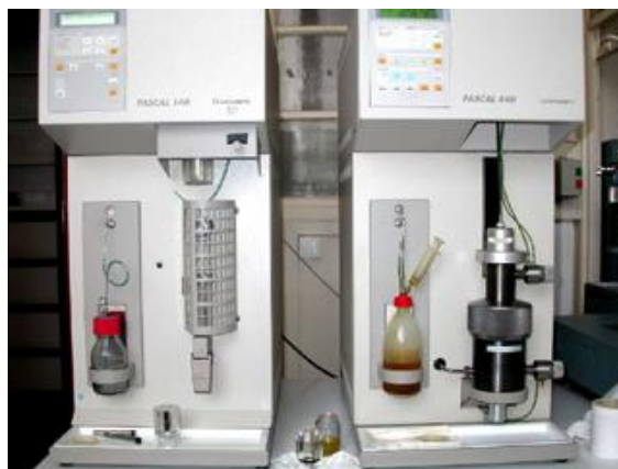
Figure II.6 porosimètre à mercure poste basse et haute pression [www.lcpc.fr]
