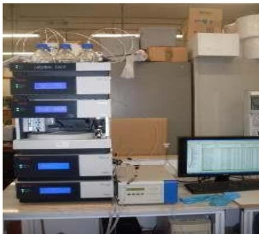
Figure 30 : Les composants d'un chromatographe liquide à haute performance (Appareil Dionex)
