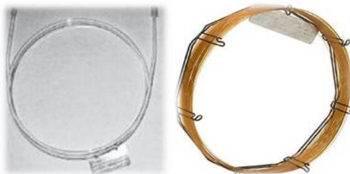
Figure 49 : Photo de colonnes remplies
