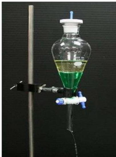
Figure 11 : L'extraction liquide-liquide
