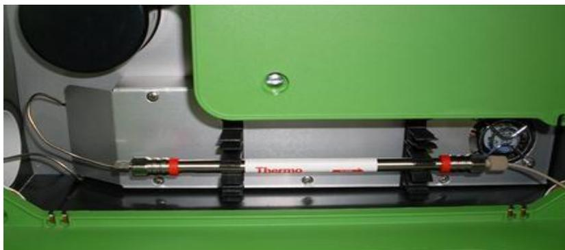
Figure 34 : Colonne dans un thermos
