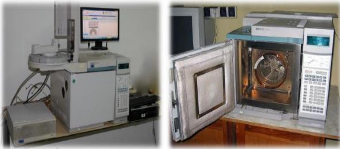
Figure 44 : Photo d'un appareil de chromatographie gaz
