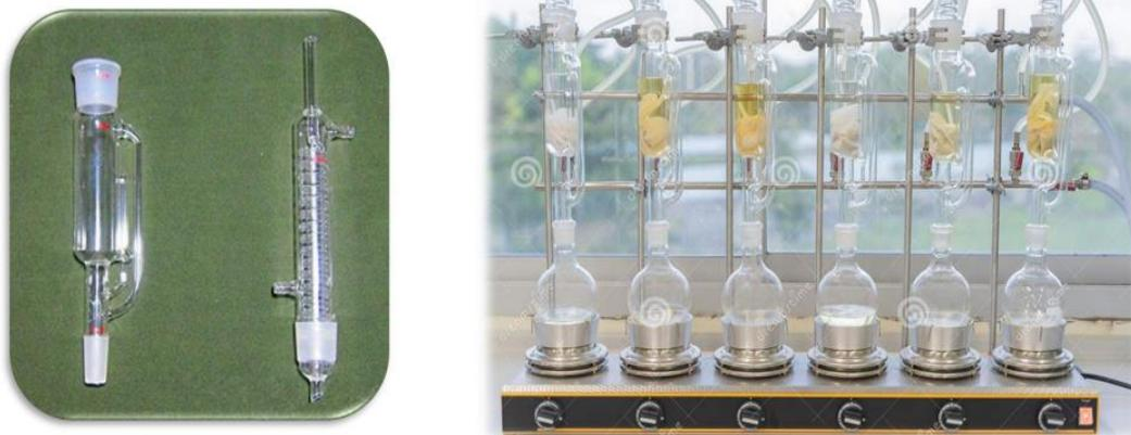
Figure 12 : L'extraction solide-liquide
